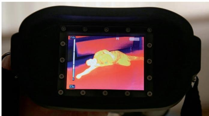
*Blick durch die Wärmebildkamera. Sie macht Temperaturunterschiede sichtbar und wird damit für Feuerwehrleute zum wichtigen Hilfsmittel bei ihren Einsätzen.*
